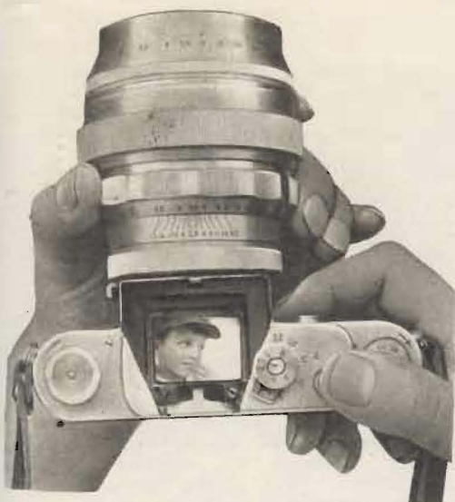
Фото 1. «Зенит» после переделки со снятой пентапризмой
